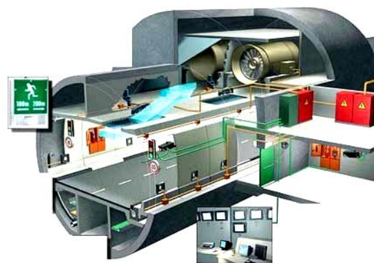
Obrázek: Průřez tunelovým tubusem s vyobrazením ventilace
